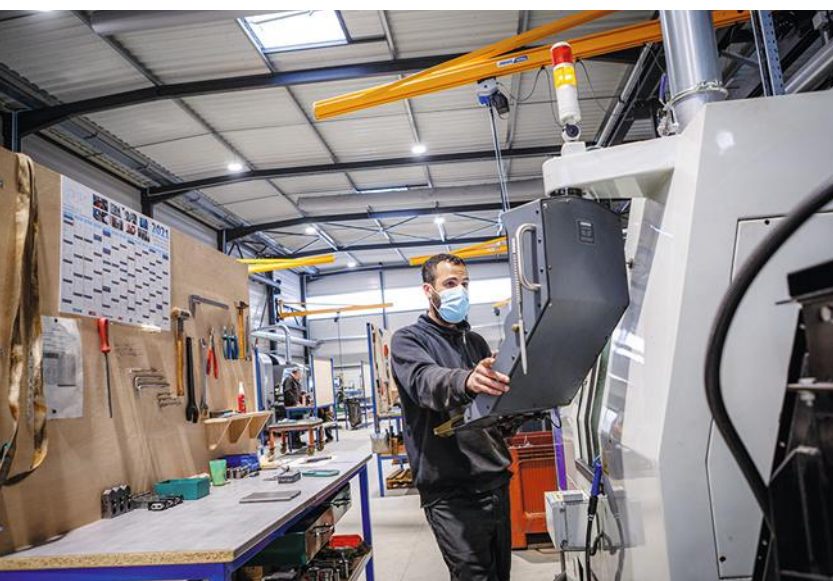
❏ Dix postes de travail ont été installés, auprès des tours d'un côté et des fraiseuses de l'autre. Chacun est doté d'un établi réalisé en interne, que chaque salarié organise comme il le souhaite.
