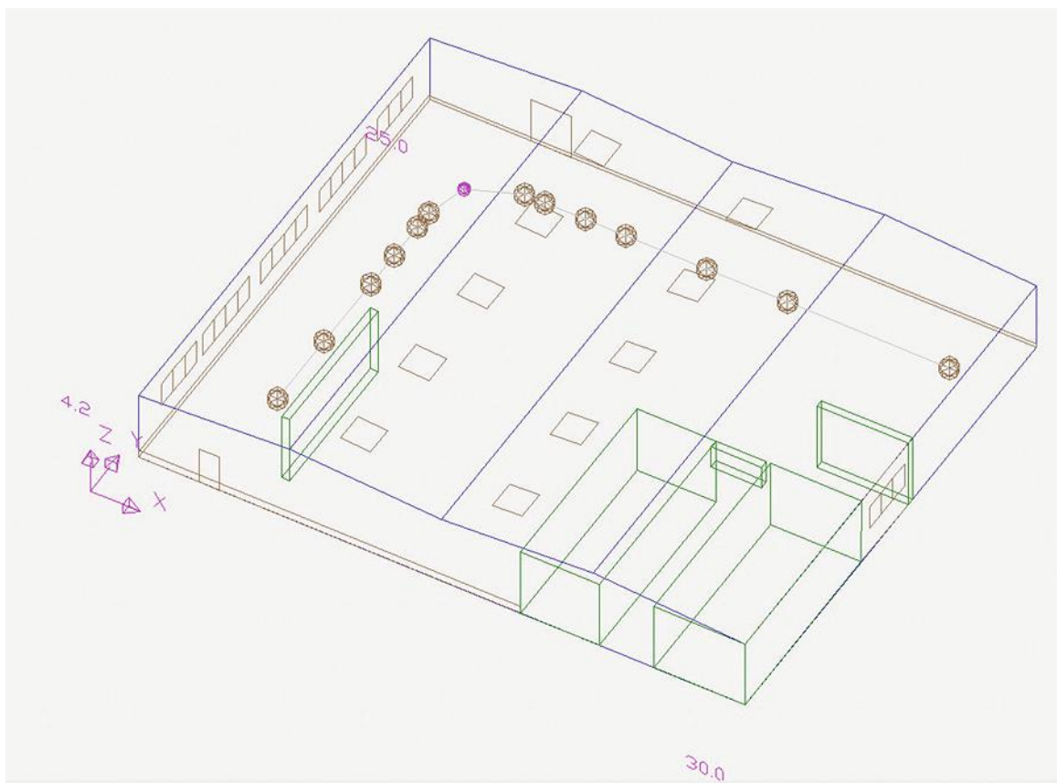
FIGURE 2 → Modèle de local et de sources sonores en entrée de calcul d'acoustique prévisionnelle.
