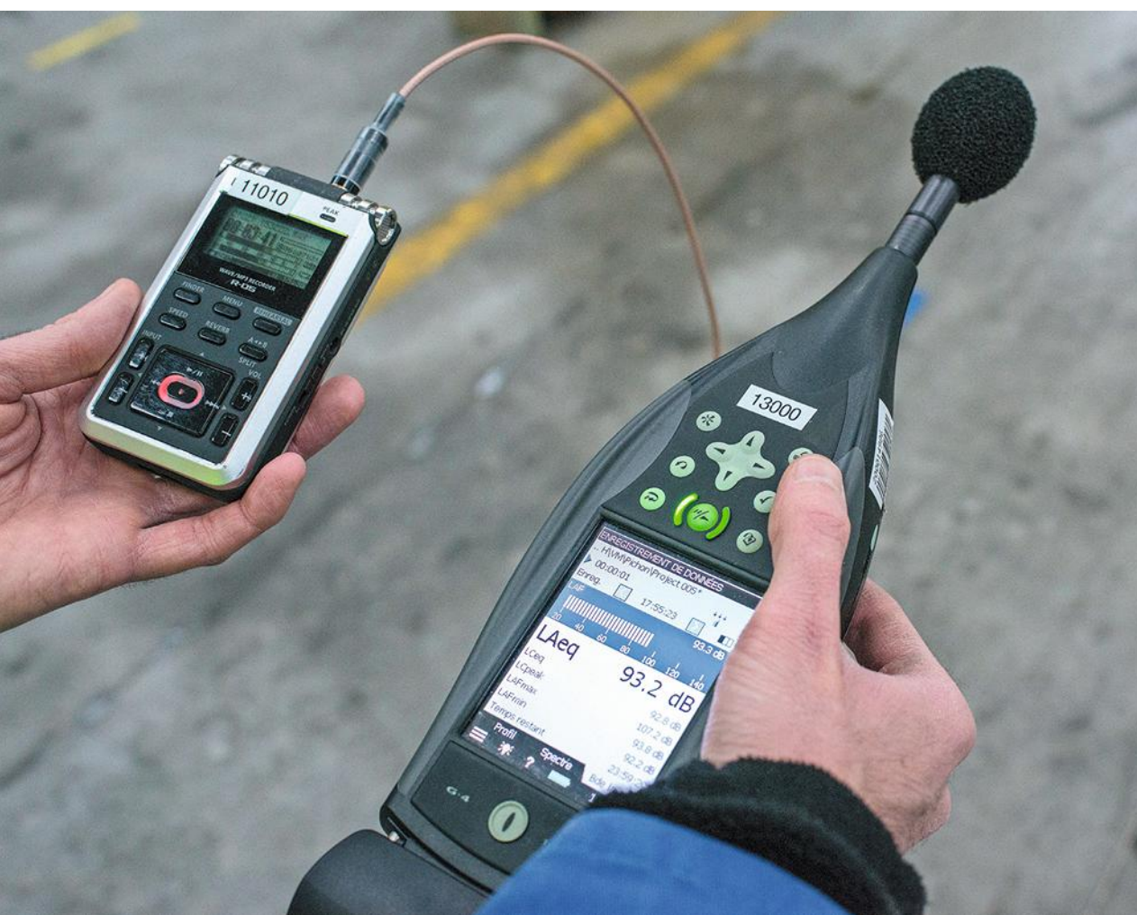
Après des simulations ou des améliorations, la mesure de bruit dans un atelier industriel peut permettre de recalibrer les prévisions sur les conditions réelles.
