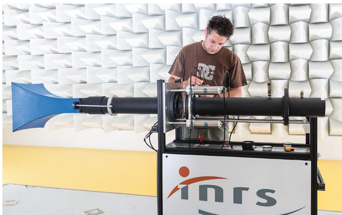
Tube à chocs dans la chambre anéchoïque de l'INRS: ce type d'expérience aide à valider les modèles.
