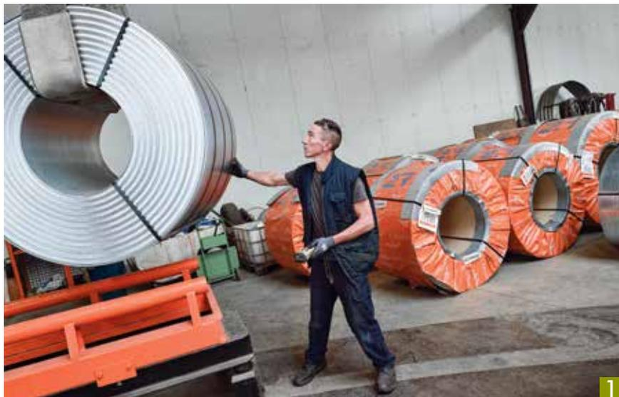
**1 Les buses** en acier galvanisé sont fabriquées à partir de bobines d'acier enroulées et serties dans l'usine.
